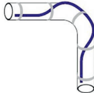
Installazione del cavo scaldante lungo le curve
